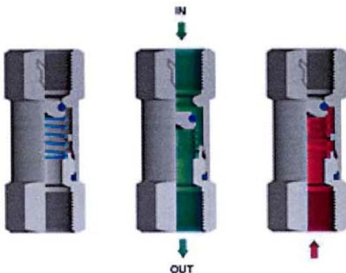
Der Durchfluss wird nur einseitig erlaubt. Im Allgemeinen ist die Richtung entsprechend dem auf dem Rückschlagventilkörper gekennzeichneten Pfeil. Die andere Seite bleibt abgesperrt.
